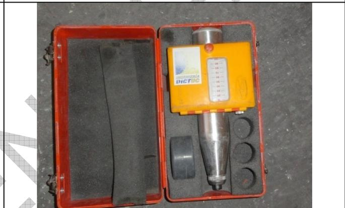
**Fotografía 12:** Martillo Schmidt utilizado para la determinación del índice esclerométrico.
