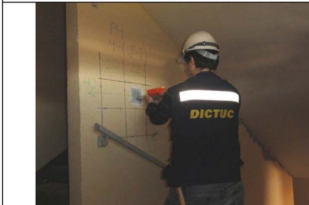
**Fotografía 11:** Determinación del índice esclerométrico en elementos de hormigón mediante Martillo Schmidt.
