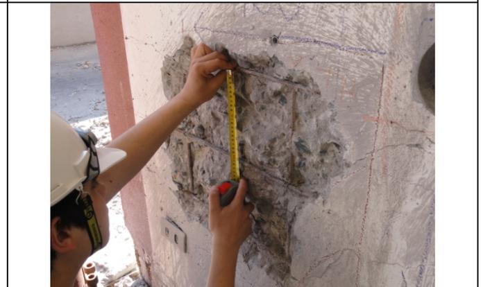
**Fotografía 25:** Vista del proceso de medición del espaciamiento de barras horizontales en uno de los muros con remoción de recubrimiento.
