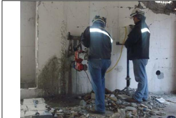
**Fotografía 5:** Vista general del proceso de extracción de testigos cilíndricos de hormigón desde uno de los elementos (muro).
