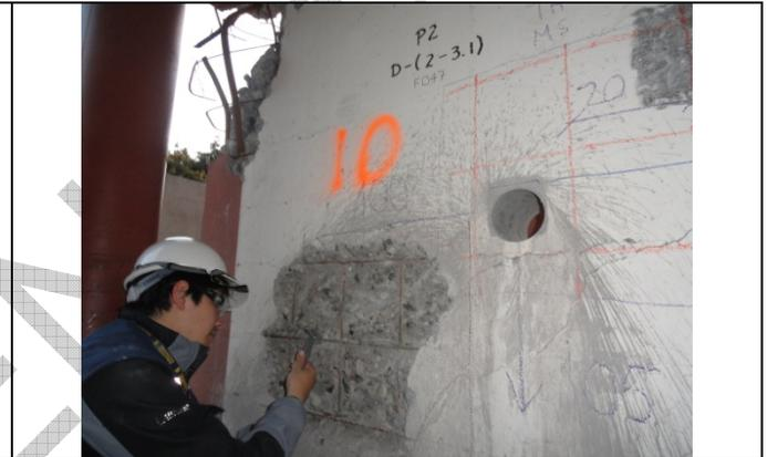
**Fotografía 23:** Vista del proceso de determinación de diámetro de barras mediante pie de metro en uno de los muros con remoción de recubrimiento.
