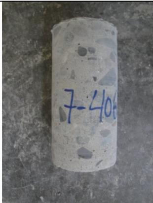
**Fotografía 7:** Testigo de hormigón una vez extraído, antes del ensayo de compresión.
