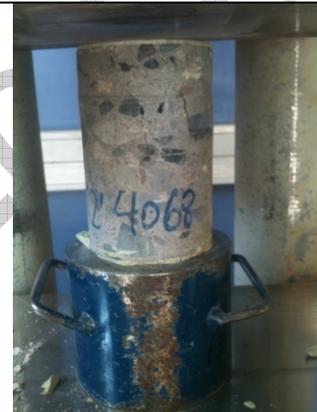
**Fotografía 8:** Testigo de hormigón una vez extraído, antes del ensayo de compresión.
