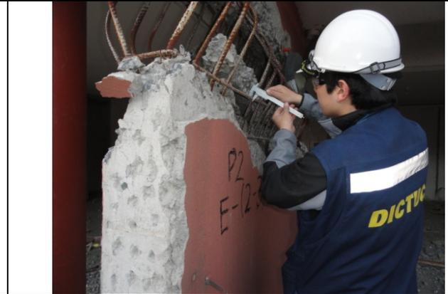
**Fotografía 27:** Detalle del proceso de medición de los diámetros de refuerzo con un pie de metro en la zona del borde del muro.
