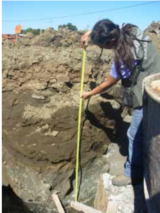
Figura 2: Se observa constitución de los suelos de fundación de las viviendas. El perfil de 1,6 m desde la superficie corresponde a lo siguiente: 40 cm de relleno antrópico compuesto de gravas y arenas; 70 cm de arcillas limosas orgánicas de color oscuro, de alta plasticidad y baja permeabilidad, bajo los cuales se reconocieron 50 cm de limos arcillosos de color gris claro derivados de suelos volcánicos.
