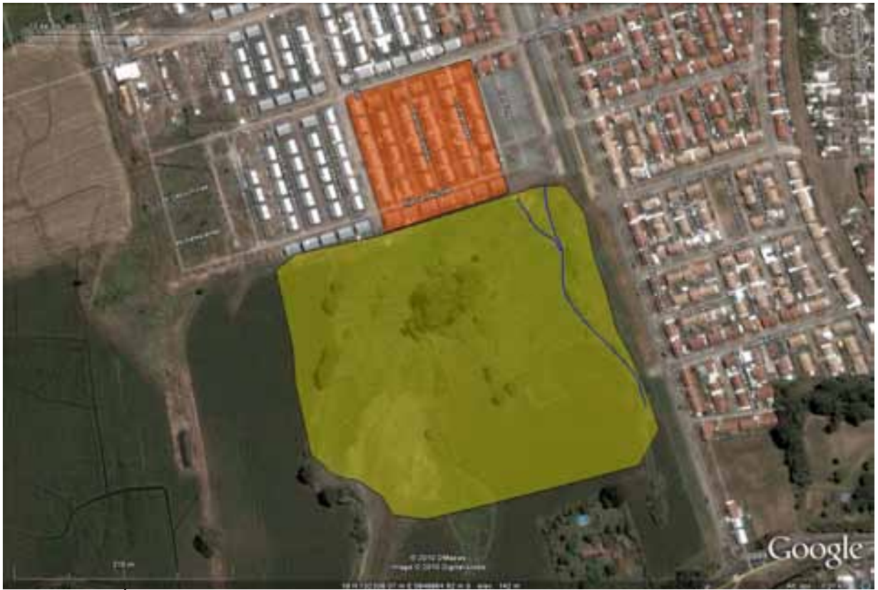
Figura 1: Los Ángeles, Villa Galilea. El polígono naranja muestra la ubicación del área visitada, afectada por asentamientos del terreno provocados por licuefacción de los suelos de fundación de las viviendas. Líneas azules muestran dirección general de escorrentía superficial. Polígono verde muestra terrenos de humedales sobre los cuales se están construyendo nuevas viviendas, las cuales también sufrieron daños durante el sismo.
