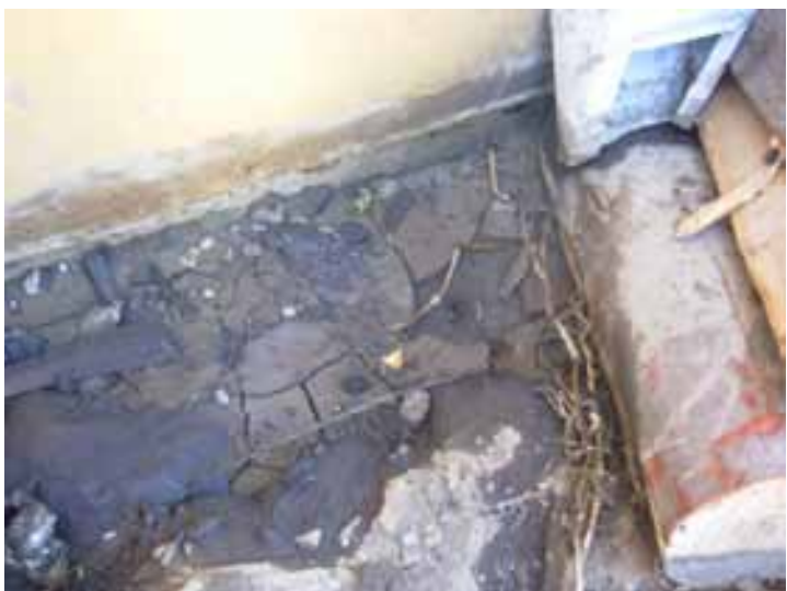
Figura 9: Muestra sedimentos de limos arenosos grises que fueron depositados por golpe de agua en el patio de una vivienda del Pje. San Ernesto (ver en la figura 2 la profundidad de limos grises).
