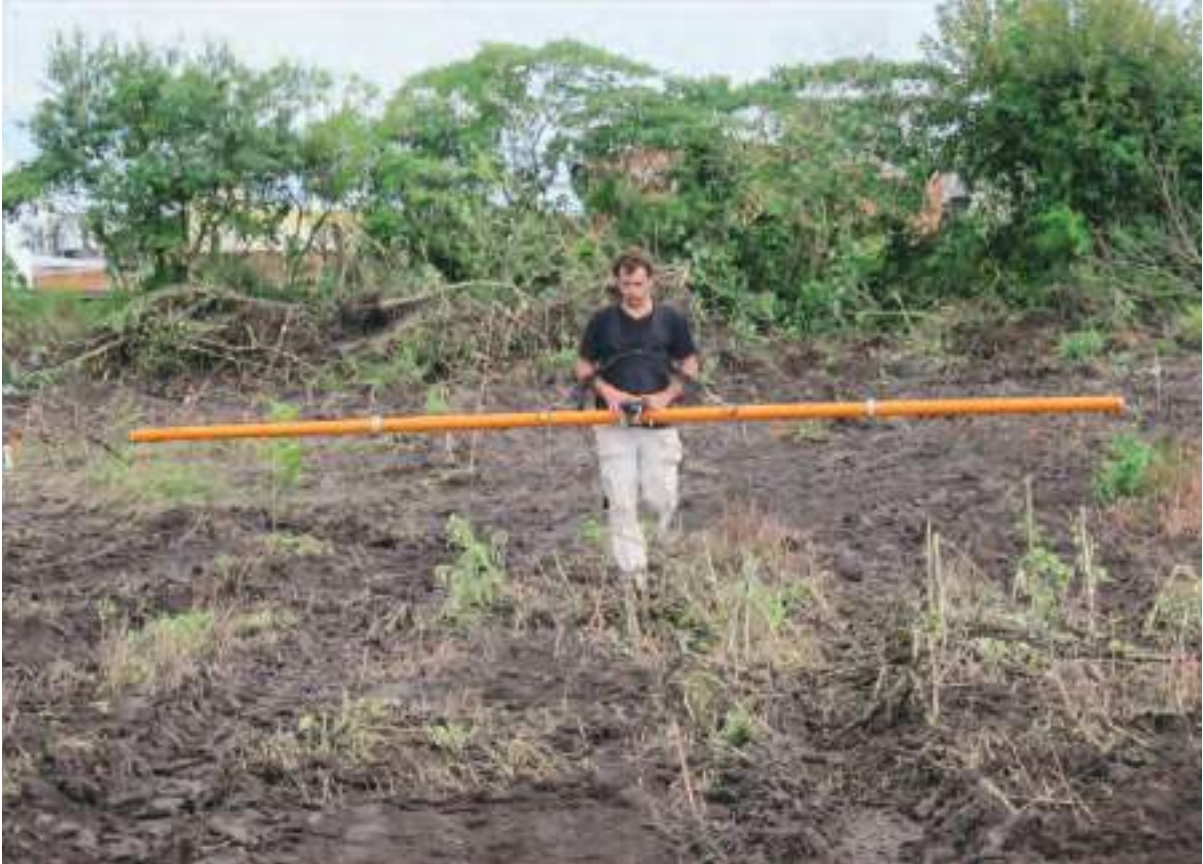
Foto 2. Uso de un método electromagnético en el campo, que tiene una barra con bobinas de cable en el interior. El cable da corriente a una determinada frecuencia y circula por el suelo y recibe señal desde el otro lado. La proporción de la señal que emite y que recibe es proporcional a la conductividad eléctrica del suelo (Foto: Santiago Perdomo).
