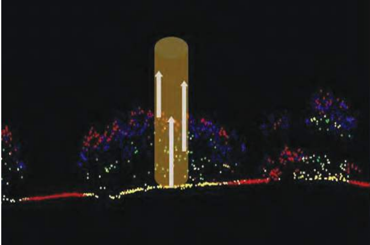
Figura 12. Corte transversal de la nube 3D de puntos LiDAR. Los puntos más bajos pertenecen al terreno y el resto a los árboles y vegetación de mediana altura. El cilindro de energía de un haz de luz láser impacta en diferentes puntos de la vegetación y el terreno, que devuelven la señal hacia el sensor ubicado en el avión (Elaborada por Daniel Del Cogliano).
