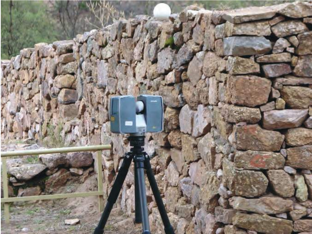
Foto 2. Escáner láser Trimble TX5 de la UNLP montado sobre un trípode. Aquí, realizando mediciones de estructuras Incas en el norte argentino (Foto: Daniel Del Cogliano).
