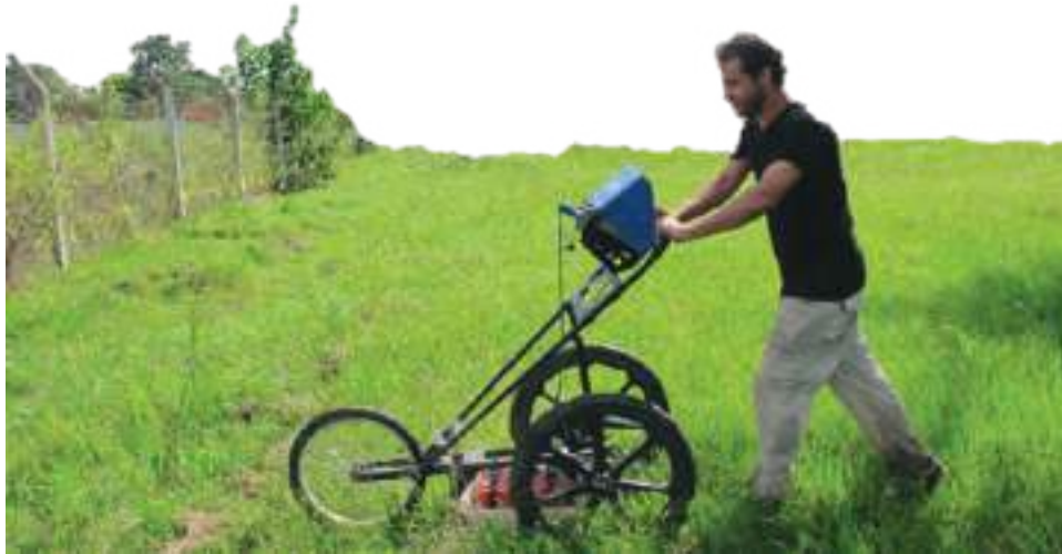
Foto 1. Uso del georadar en el campo. Este método electromagnético utiliza ondas con altas frecuencias para detectar cambios en las propiedades eléctricas del subsuelo. La cortadora de pasto envía un pulso electromagnético y recibe los rebotes de esa señal del subsuelo, y dichos rebotes producen una imagen llamada radargramas (Foto: Santiago Perdomo).
