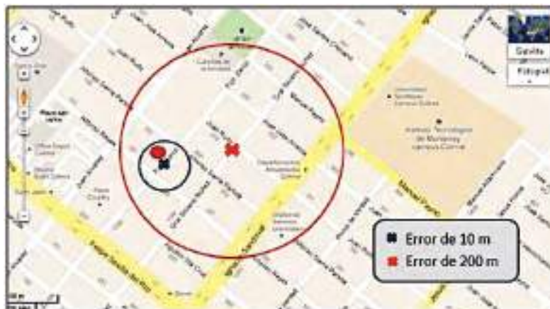
Figura 6. Las cruces muestran los resultados de dos determinaciones de coordenadas con navegadores GPS. La azul tiene un error o incertidumbre mucho menor a la determinación roja. Eso se refleja primero en los círculos de error y segundo en la proximidad al valor que sabemos real (Adaptada por Daniel Del Cogliano de https://www.google.com/maps/@19.2571146,-103.713925,16z ).
