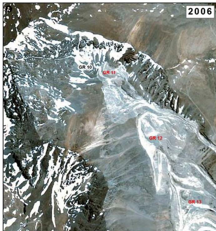
Figura N° 3: Construcción de caminos sobre glaciares rocosos en el área Oriente de Minera Los Pelambres.
